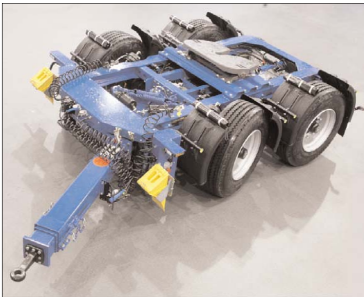
Abb. 4-4: Lenkbare Dollyachse der Firma Krone (2006)
