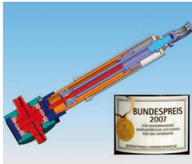
CAD-Modell des Hydraulikzylinders
