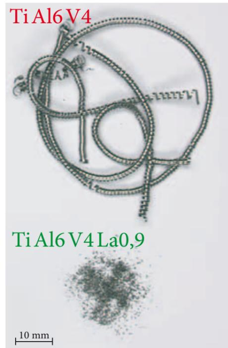
Späne TiAl6V4 (oben) und Spanfragmente TiAl6V4La0,9 (unten)
