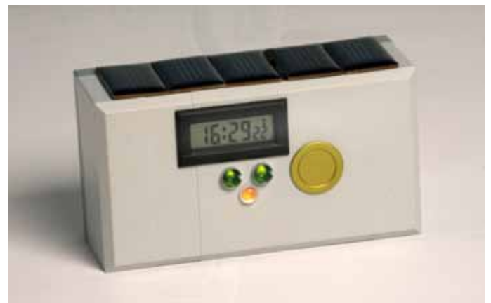
„Call-Button“ für Materialanforderungen mit Solar-Betrieb
