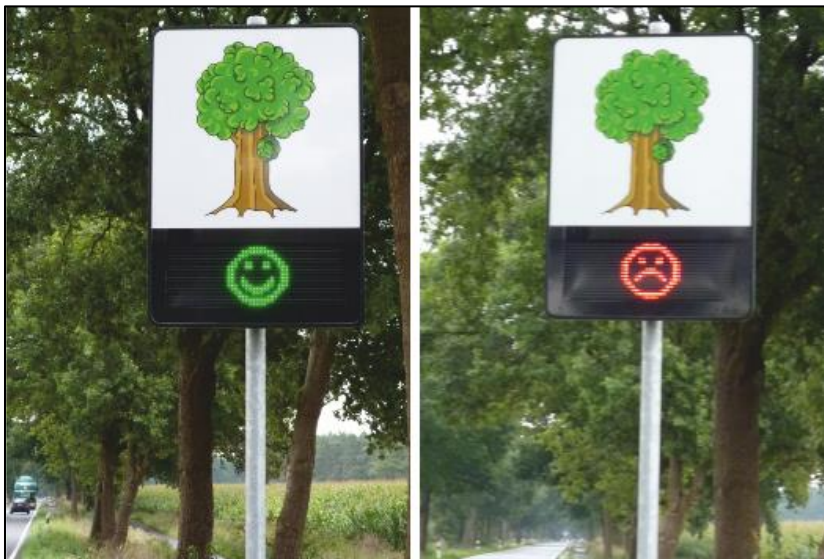
Abbildung 4.2: Dialogdisplay mit positiver und negativer Rückmeldung
