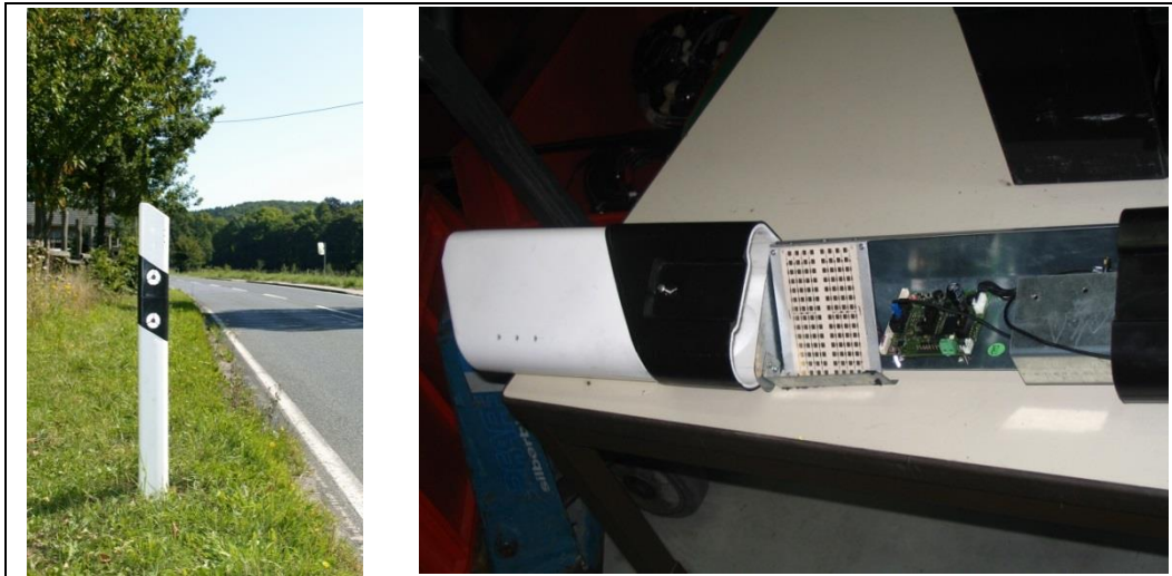
Abbildung 4.7: Leitpfostenzählgerät (Quelle: RTB GmbH & Co. KG)
