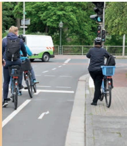
Linksabbiegende Radfahrende sowie rechtsabbiegende Kfz-Führende haben hier getrennte Schaltungen.
