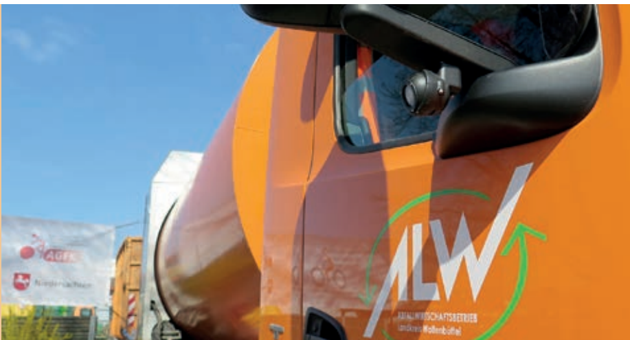
Die kleine Kamera unterhalb des Seitenspiegels schafft 120 Grad zusätzlichen Blickwinkel.
