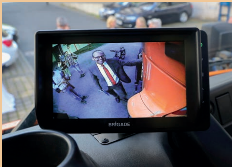
Der Monitor in der Kabine ergänzt die Seitenspiegel und verschafft einen besseren Überblick beim Rechtsabbiegen, wie Ulf-Birger Franz, Verkehrsdezernent der Region Hannover, demonstriert.
