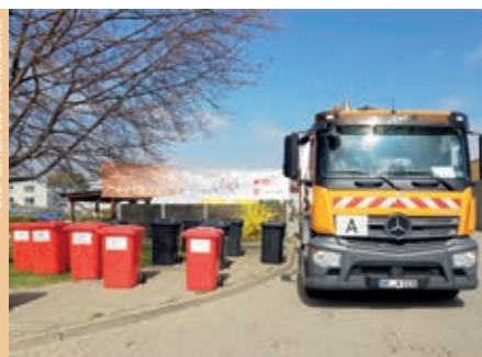
Die roten Tonnen zeigen, wo sich der für Lkw-Fahrende schwer einsehbare Bereich befindet.
