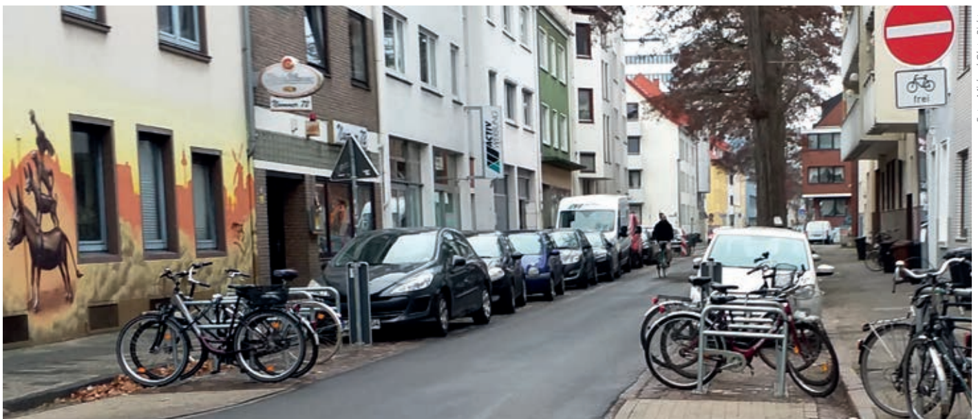
Parkstreifen neu definiert: Fahrrad- statt Pkw-Parken. Zusätzlich schaffen Gehwegnasen Klarheit im Straßenraum und mehr Platz für das Fahrradparken.
