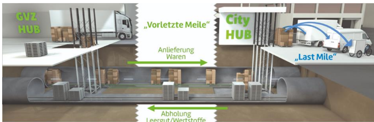
Abbildung 3-11 Funktionsweise des Smart City Loop
