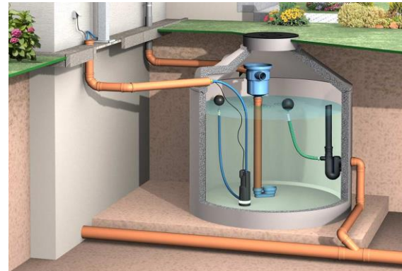
Abb. 1: Retentionszisterne (Bernhard Müller Betonsteinwerk GmbH 2020)
