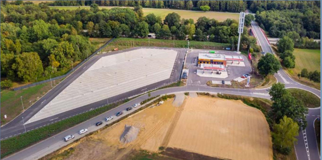
Durch ein telematisch gesteuertes Parksystem, dem sogenannten Kolonnenparken, kann der Autohof bei gleicher Flächenbeanspruchung die Anzahl der LKW-Stellplätze von 57 auf 100 erweitern. Dies stellt ein anschauliches Beispiel für die Steigerung der Nachhaltigkeit und Effizienz im Verkehr durch Digitalisierung dar.
