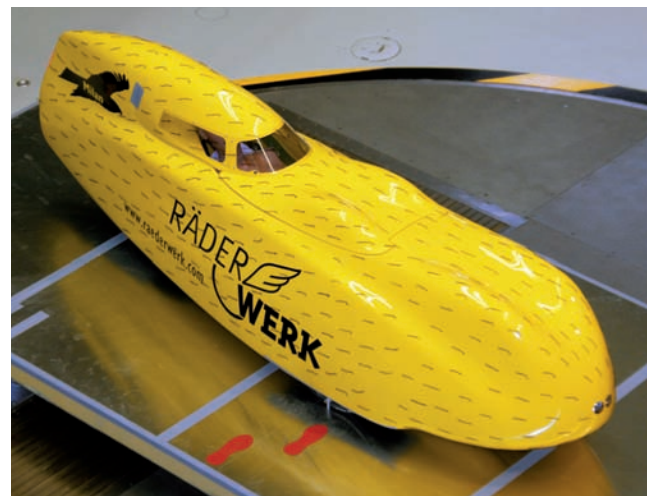
Strömungssichtbarmachung mit Wolffäden bei Seitenwind
