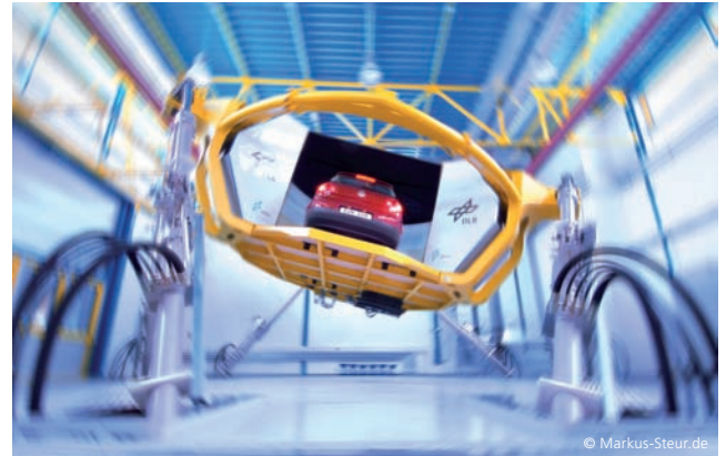
Dynamischer Fahrsimulator im DLR Braunschweig, Institut für Verkehrssystemtechnik
