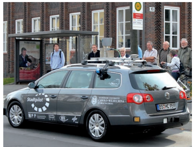
Weltpremiere: Forschungsfahrzeug „Leonie“ fährt automatisch und ohne eingreifenden Fahrer durch den Stadtverkehr
