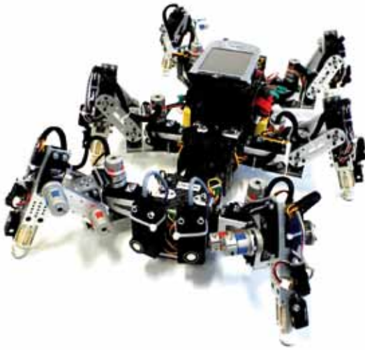
AMOS: Sechsheiniger Roboter, der verschiedene Verhaltensweisen erzeugen kann.
