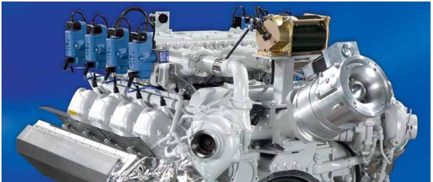
MOTORTECH Biogas-Zündung, mit Zündungs-Verkabelungsschienen, Zündspulen, Gasmischer und Sensorverkabelung auf einem modernen 8 Zylinder Gasmotor
