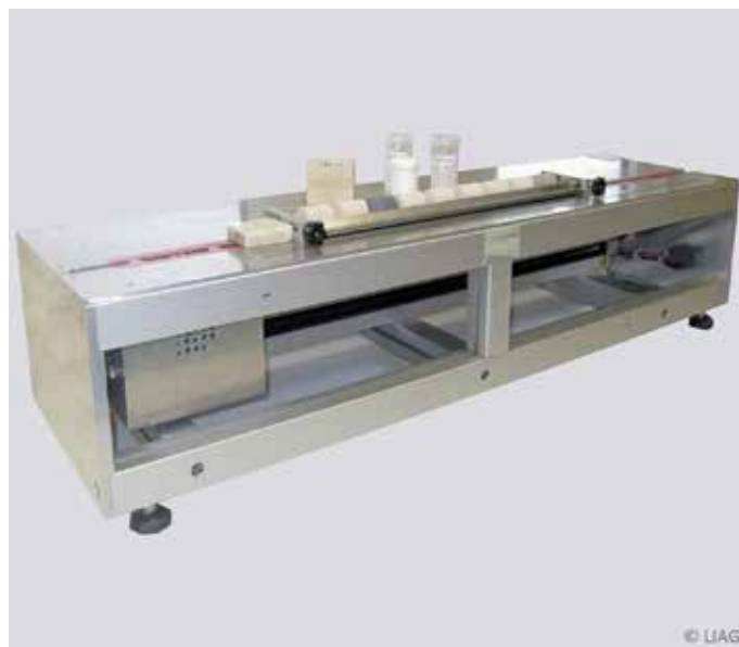
Thermoscanner ermittelt Wärmeleitfähigkeit von Gesteinen
