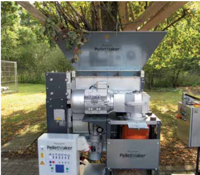
Zerkleinern und Formpressen in einer Anlage
